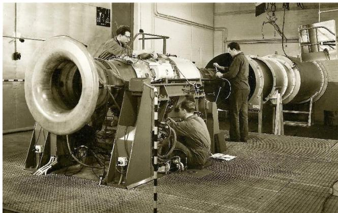
Bis August 1966 sind 358 Neubautriebwerke über die „Orpheus-Prüfstände“ gelaufen, und im Rahmen der von Anfang 1963 bis August 1982 währenden Betreuungsphase sind ihnen auf den Zwillingsprüfständen insgesamt 3.044 Triebwerke mit ihrem Abnahmeprüflauf gefolgt.
